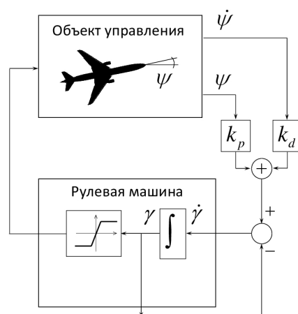
Рис. 3.3.3. Схема автопилота, управляющего курсом самолета.
